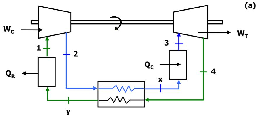
10. A partir del siguiente diagrama T-s correspondiente a un ciclo Brayton con recalentamiento intermedio, represente su correspondiente diagrama de bloques:
